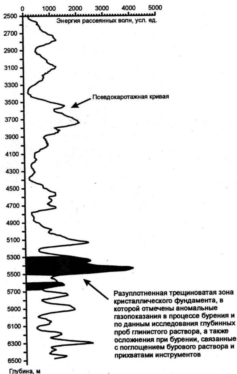
Рис. 3. Распределение энергии рассеянных волн (псевдокаротажная кривая) вдоль скважины 20009
